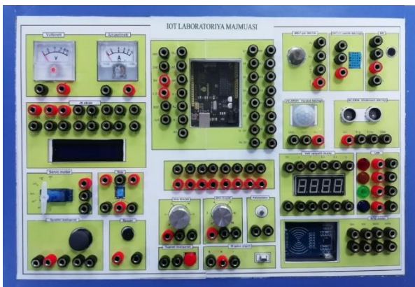
Рисунок 1. Стенд для практической реализации умного оборудования и подключения к нему датчика.
