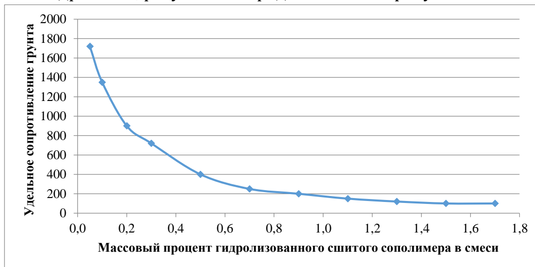
Рисунок 3. Зависимость удельного сопротивления грунта от содержания в нем активированного гидрогеля.
