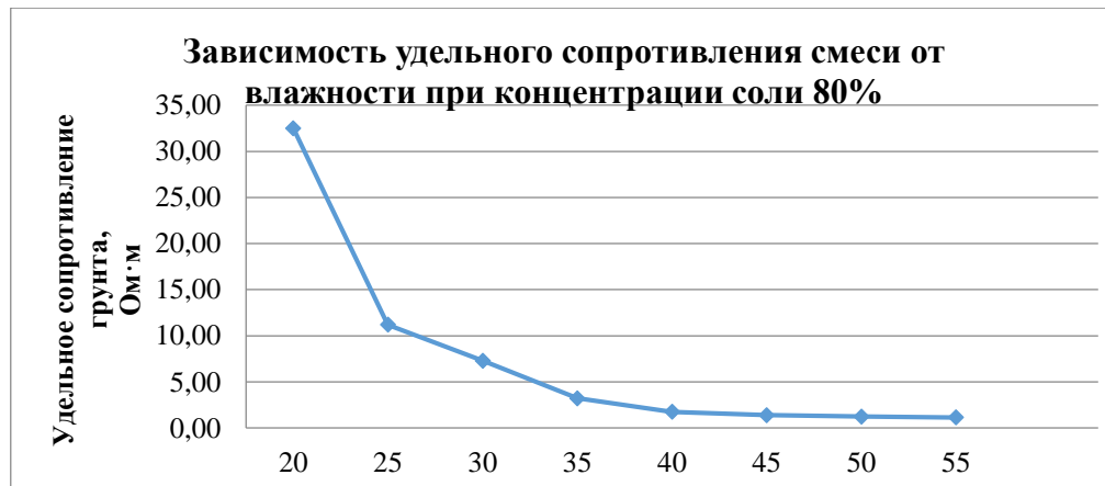
Рисунок 6. Зависимость удельного сопротивления смеси от влажности, при массовой доле соли 80%.
