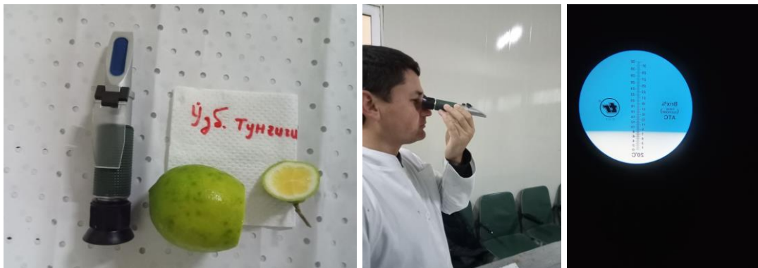
1-rasm. Limon mevalari tarkibidagi qand miqdorini aniqlash
